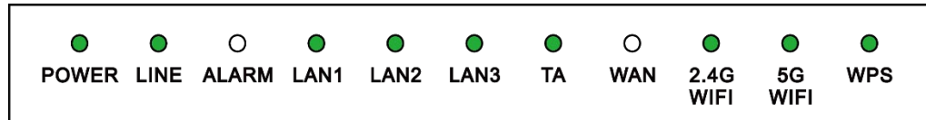
図 4-2 本製品が外部デバイスへの接続に成功した場合に点灯する LED
